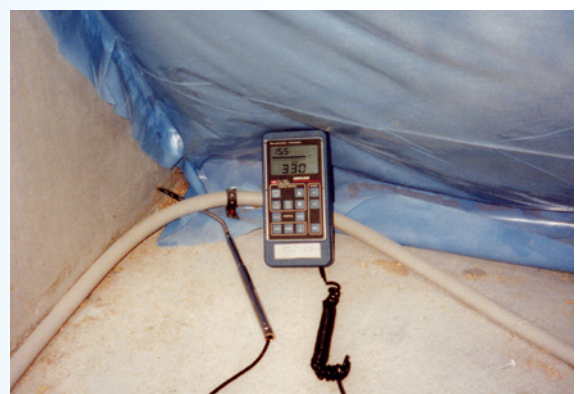
Leckageortung mit dem Anemometer
